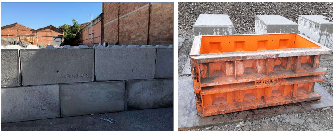
FIGURE 3 : EXEMPLE DE GAMME DES PRODUITS A BASE DE BETON DE MACHEFERS UTILISABLES EN CONSTRUCTION NOTAMMENT
